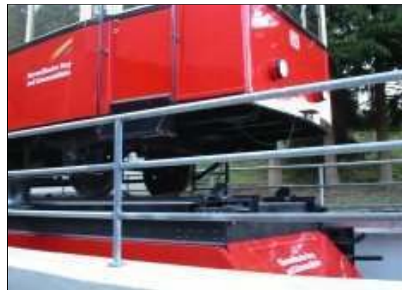
Standseilbahn Oberweissbacher Bergbahn. Güterbühne mit normalspurigem Wagen. Links Plan aus der Website der Oberweissbacher Bergbahn
